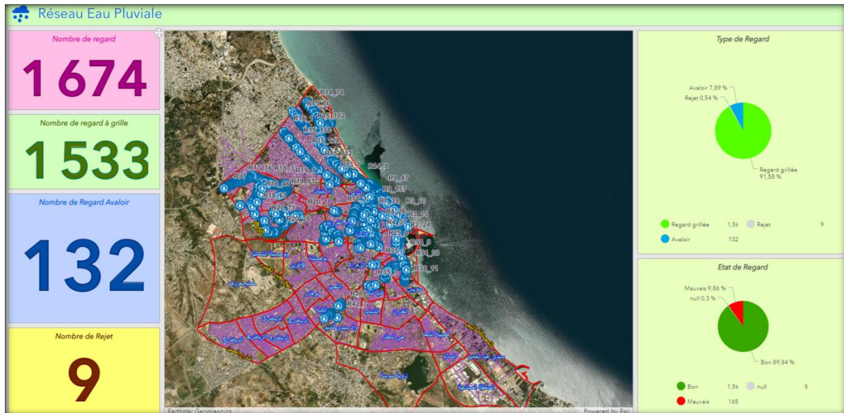
Figure 23: Tableau de bord des regards d'eaux pluviales
