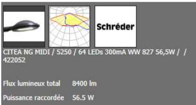
Figure 8: luminaire dos à dos cheminement intérieur place
