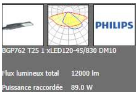
Figure 31: luminaire LED pour l'éclairage des voies secondaires classées en C3
